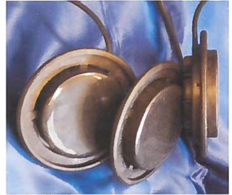
Abbildung 1: Kostengünstige Ultraschallwandler zur Trockenankopplung
