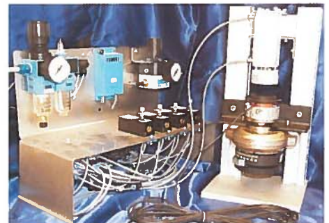
Abbildung 2: Prüfgerät zur Charakterisierung der Abriebfestigkeit der Ankoppelschicht
