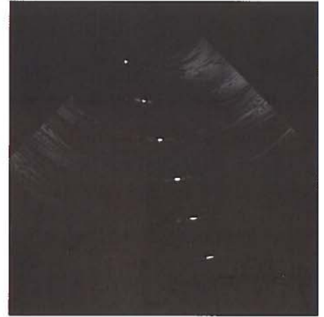
Bild 3: B-Bild eines Drahtphantoms, das mit einem Sparse-Array aufgenommen wurde (Aufnahme: University of Oslo)
